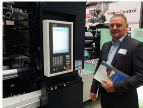
Die Steuerung IMC 500 paart intuitive Bedienbarkeit und modernes Design dank eines web-basierenden 24-Zoll-Multitouch-Bildschirms
