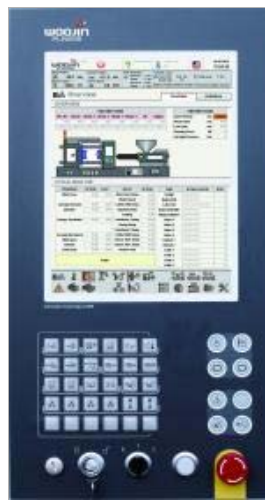
Die Bearbeitungszeit der Signale der Maschinensteuerung PP580 liegt bei unter 0,4 ms.
